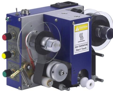
氣壓式碳帶印字機 PE-200 可安裝於直立式連續或間歇作動包裝機上，氣壓式驅動使打印速度可達每分鐘 120 次，確實符合一般包裝機之需求。其能準確打印製造日期、有效日期、保存期限及批號等生產資料。適應材質為紙盒、塑膠袋、真空包裝袋、鋁箔袋等大部份軟性包材。
